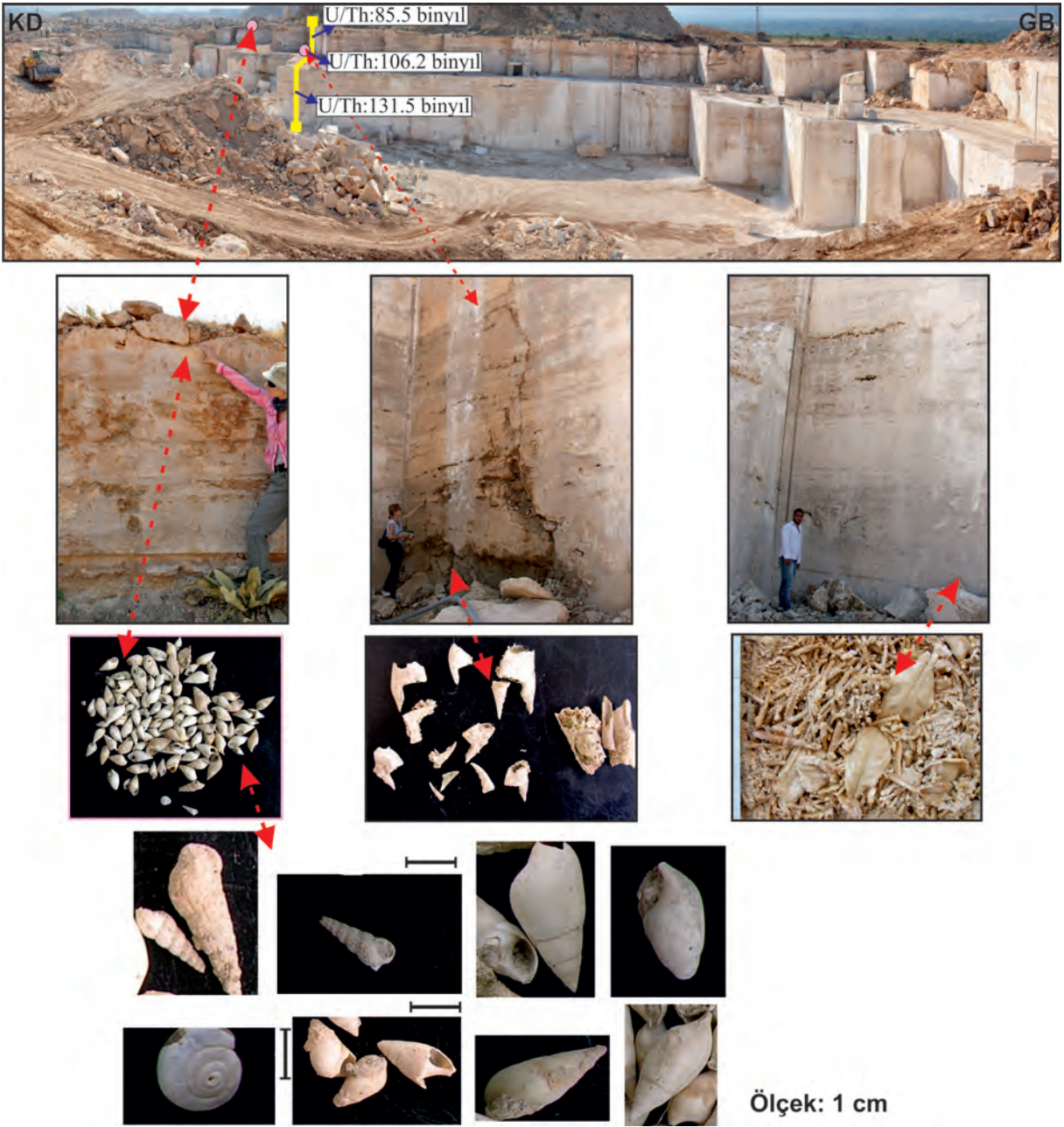
Şekil 3. Gürlek-Kocabaş traverten ocağının panoramik görünümü (bakış yönü KB) (Toker vd., 2015). Traverten aynalarının yakından görünümü (orta) ve durgun havuz ortamını karakterize eden gastropod kavkuları (detay görüntüleri en altta), yaneç parçaları ve ayrıca fosilleşmiş bitki sap ve yaprakları.
